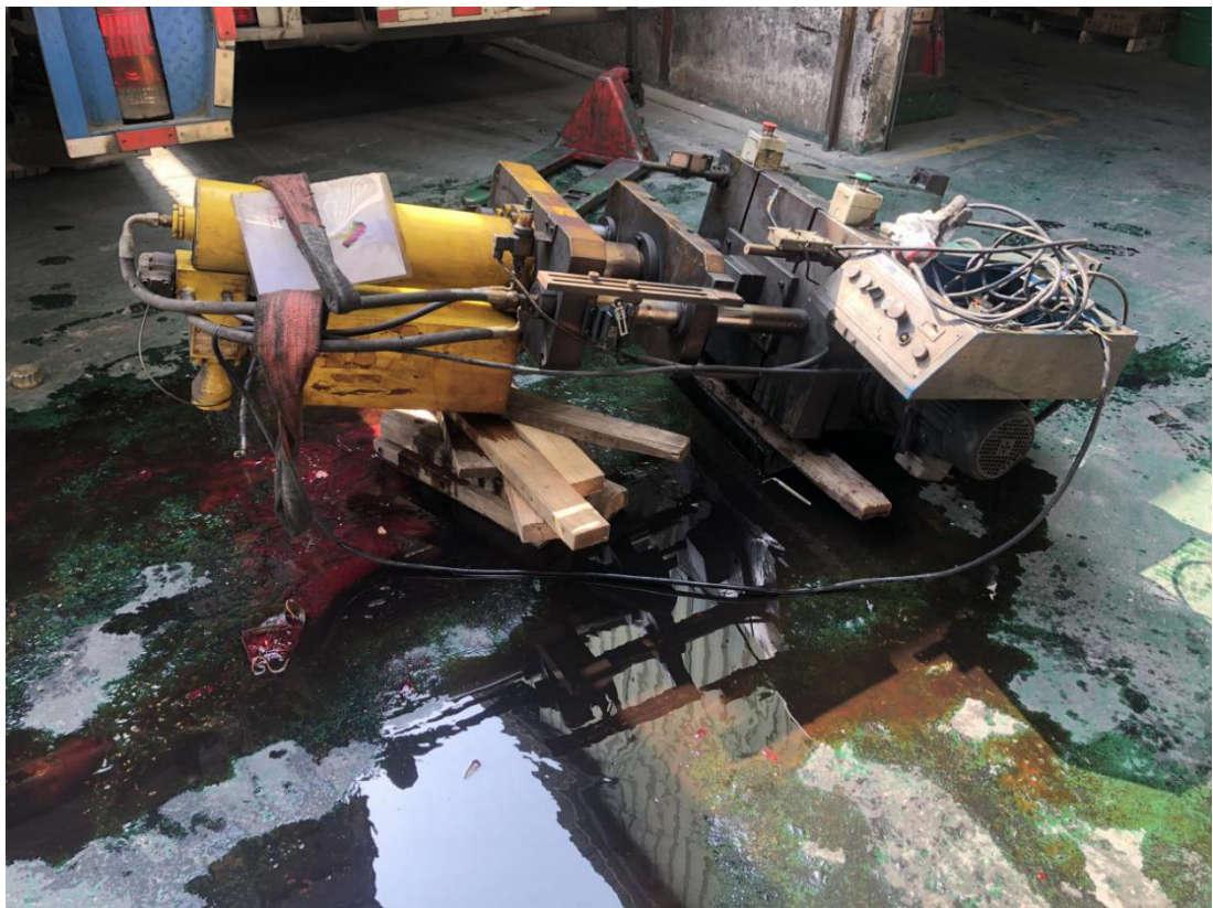
(图 3: 事故现场涉事液压机倒地状态)
