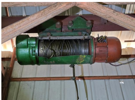
图 6 设备顶部电动葫芦
