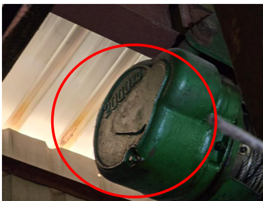
图 7 电动葫芦侧面显示的载重量
