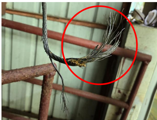
图 10 设备钢丝绳断裂脱钩
