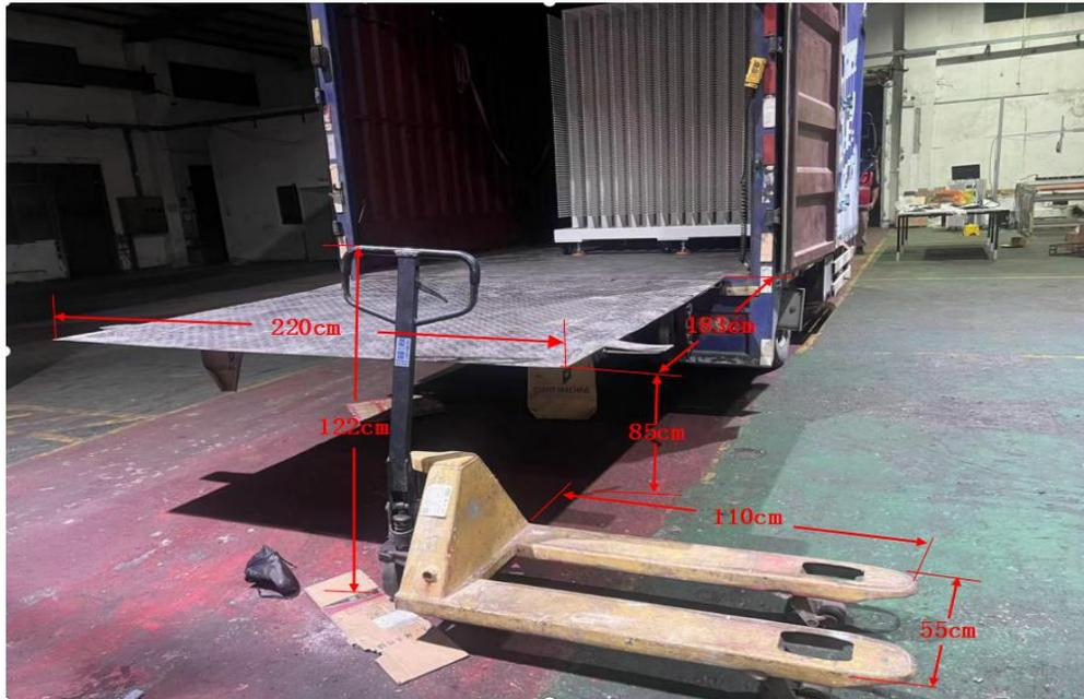
图4 涉事手推叉车、车厢尾板等尺寸示意图
